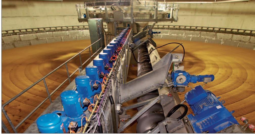
Einer von 3 Keimkästen mit einem Durchmesser von 35 m.
